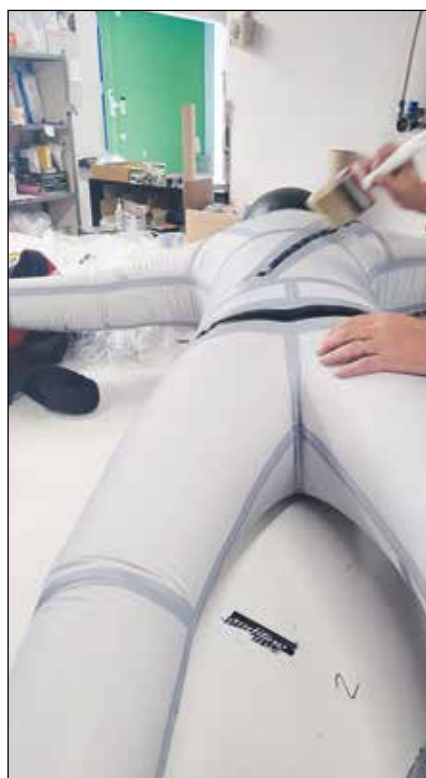
TEST DRYSUIT SOTTO PRESSIONE.
