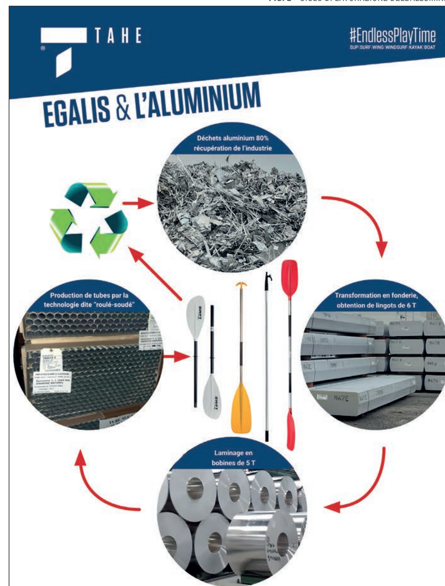
FIG. 2 - CICLO DI LAVORAZIONE DELL'ALLUMINIO.
