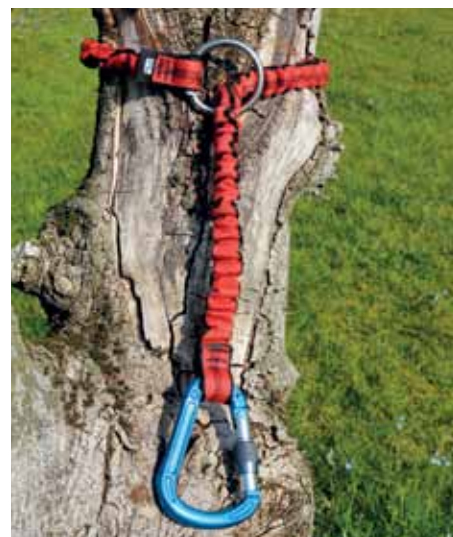
COWTAIL USATO COME ANCORAGGIO DI EMERGENZA.
