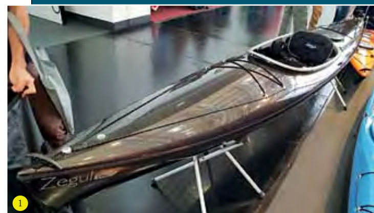
FOTO 1: KAYAK DA TURISMO IN CARBONIO (VEDI PARTICOLARE LAVORAZIONE DEL TESSUTO) E RESINA EPOSSIDICA (EPOXY). CON LA TECNOLOGIA AD INIEZIONE (INJECTOR) VIENE CREATO IL VUOTO E INIETTATA LA PRECISA QUANTITÀ DI RESINA SUFFICIENTE PER IMPREGNARE I TESSUTI EVITANDO COSÌ DI USARE PIÙ MATERIALE DEL NECESSARIO LIMITANDO I PESI ED ELIMINANDO COMPLETAMENTE TUTTE LE BOLLE D'ARIA CHE DIMINUISCONO RIGIDITÀ E ROBUSTEZZA.
