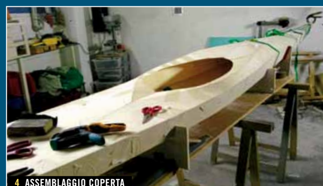
4 ASSEMBLAGGIO COPERTA
