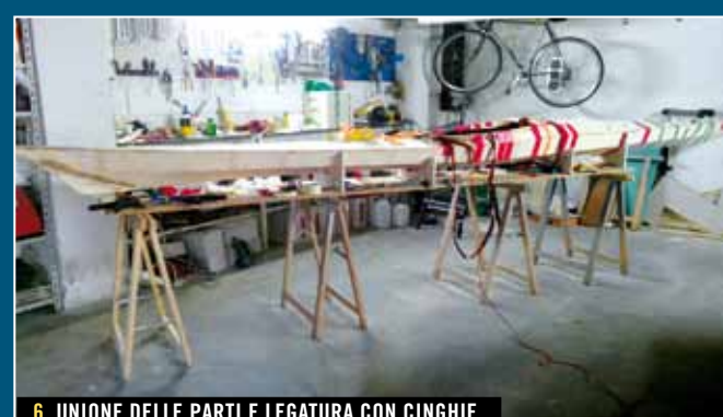
6 UNIONE DELLE PARTI E LEGATURA CON CINGHIE
